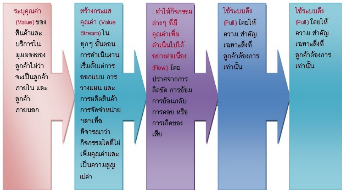
รูปที่ 2 แผนภาพแนวคิดของระบบการผลิตแบบลีน
